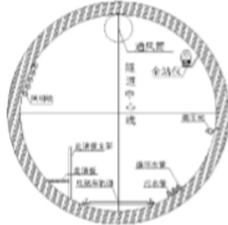
盾构隧道内管线布置剖面示意图
